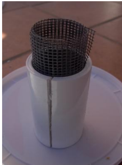
شکل ۱۸- قرارگیری توری پلاستیکی درون لوله پلی‌پروپیلن
