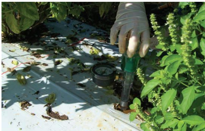
شکل ۱۴- نصب تانسومتر در چاهک حفر شده
