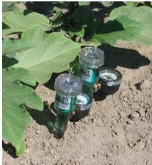
شکل ۱۶- محل نصب تانسیومتر در اطراف گیاه به منظور تعیین رطوبت خاک
