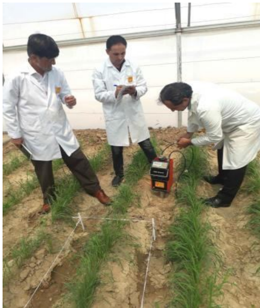
شکل ۲۹- نمونه‌ای از دستگاه نوترون‌متر به‌منظور تعیین رطوبت خاک
