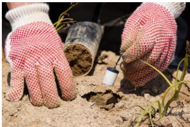
شکل ۲۵- نحوه جایگذاری بلوک گچی آماده شده در خاک
