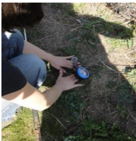
شکل ۱۵- پر کردن اطراف لوله تانسومتر با خاک به منظور جلوگیری از تجمع آب در اطراف لوله
