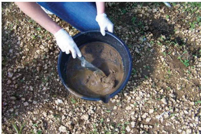
شکل ۱۲- مخلوط کردن خاک الک شده با آب به‌منظور ساختن دوغاب
