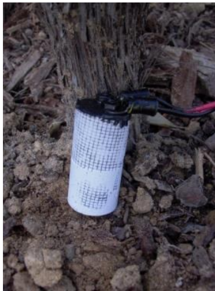
شکل ۲۲- نمونه‌ای از بلوک گچی آماده شده
