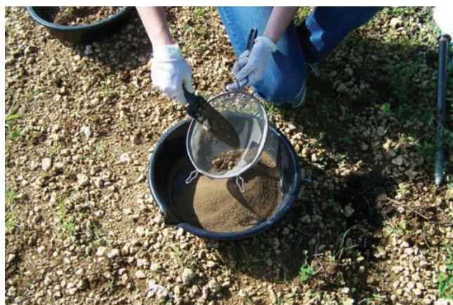
شکل ۱۱- الک کردن خاک نرم به منظور ساختن دوغاب
