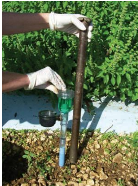
شکل ۹- انتخاب میله مناسب برای ایجاد چاهک برای نصب تانسیومتر در مزرعه
