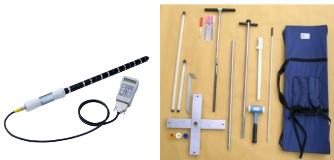
شکل ۲۷- نمونه‌ای از دستگاه اندازه‌گیری رطوبت خاک به روش FDR و تجهیزات نصب آن
