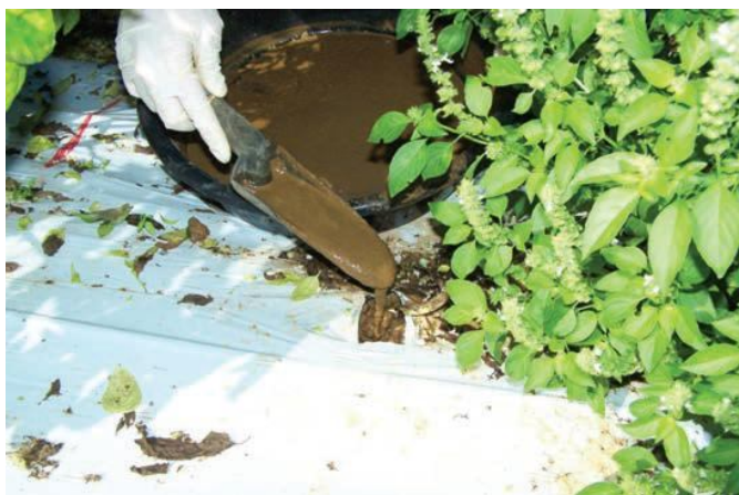
شکل ۱۳- ریختن دوغاب گل در سوراخ حفر شده برای نصب تانسومتر
