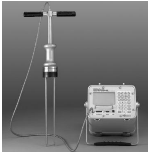
شکل ۲۶- نمونه‌ای از دستگاه اندازه‌گیری رطوبت خاک
