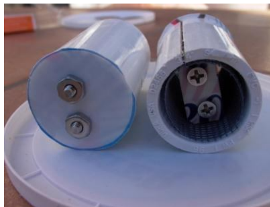
شکل ۱۹- قرارگیری پیچ‌های فلزی درون لوله پلی‌پروپیلن
