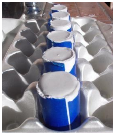
شکل ۲۱- ریختن گچ در قالب‌های آماده شده
