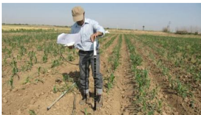
شکل ۲۸- اندازه‌گیری رطوبت خاک با استفاده از روش TDR
