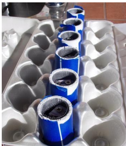
شکل ۲۰- آماده‌سازی قالب‌ها به منظور ریختن گچ
