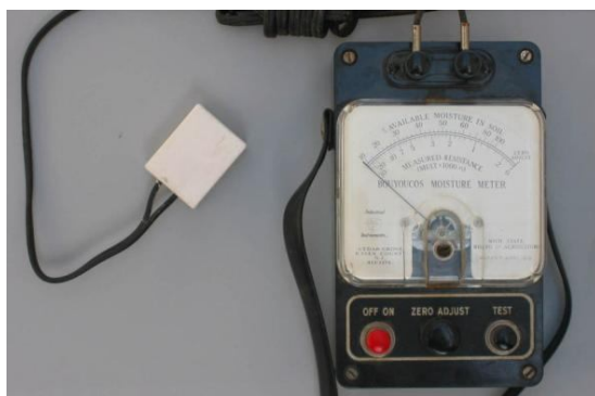
شکل ۲۳- نمونه‌هایی از دستگاه مقاومت سنج بلوک گچی
